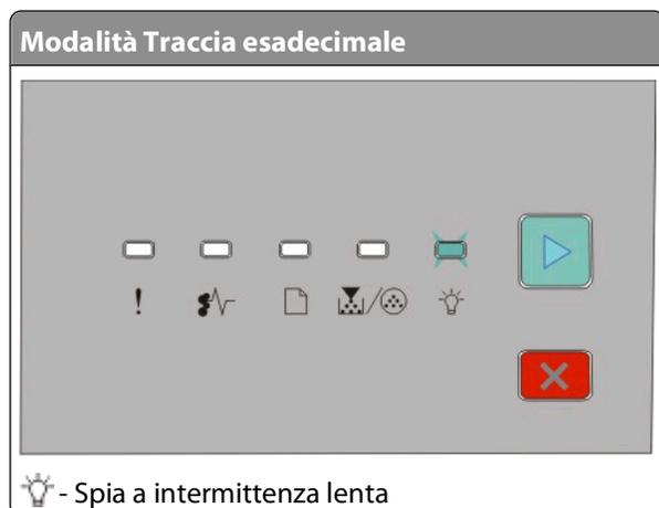
Verificare che la stampante non si trovi in modalità Traccia esadecimale. Se viene accesa la sequenza di spie della "modalità Traccia esadecimale", è necessario uscire dalla modalità Traccia esadecimale prima di stampare il processo. Per disattivare tale modalità, spegnere e riaccendere la stampante.
